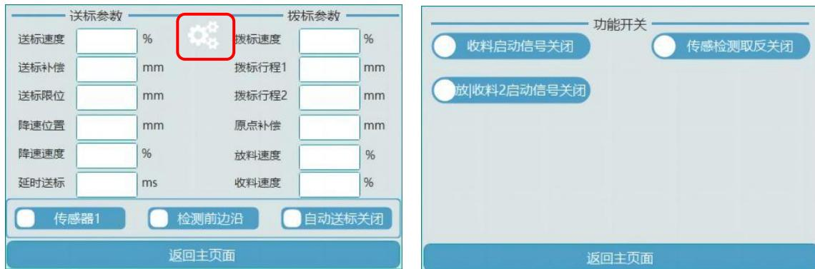
功能开关进入方式：先进入送标参数界面，后点击中上方“3个齿轮”即可进入
