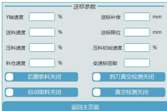
Y 轴速度：Y 轴移动速度，单位/%，例：Y 轴电机最大转速 1200r/min，Y 轴
