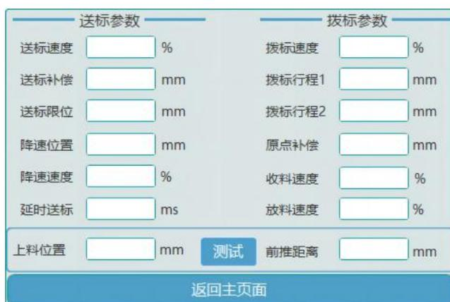
飞达送料速度可分为两段：快速走定长+慢速寻标（保证送料速度的同时又保证供料的精度）
